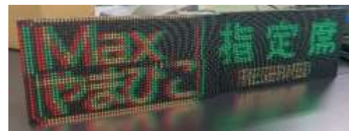
図5 128x32マトリクスパネルが動作している様子
