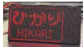
図4 64x32マトリクスパネルが動作している様子
